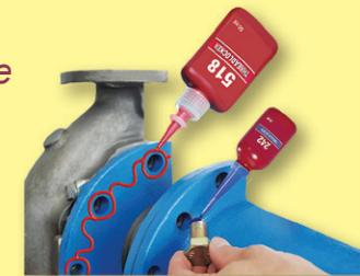
Анаэробные герметики – это однокомпонентные уплотнители, которые полимеризуются при отсутствии воздуха и контакте с плотно прилегающими металлическими поверхностями. В результате образуется жесткая и нерастворимая пластмасса, которая заполняет зазор между соединяемыми элементами и предотвращает утечку среды. В 10 раз надежнее и прочнее льна и ФУМ-ленты. Оптимальны для установки кранов и клапанов.
